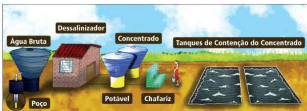
**Figura 4** – Sistema de Dessalinização Adotado pelo PAD
